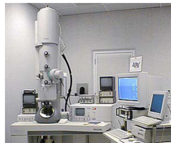
**투과 전자 현미경 (Transmission Electron Microscope, TEM)
