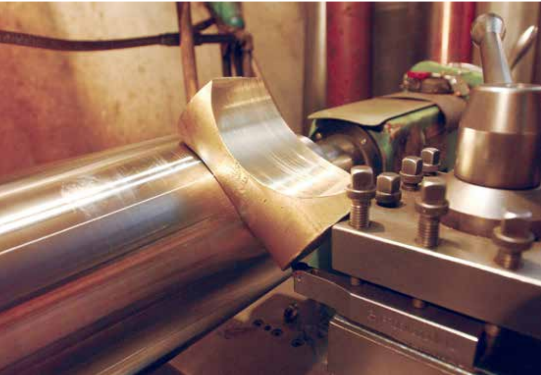
기계 위에 놓인 황금색 보조기구가 기계 가동 시 진동을 막아주는 특허품이다. 간단한 모습의 쇠덩어리이지만 수천번 시행착오 끝에 발명한 기구라 한다
